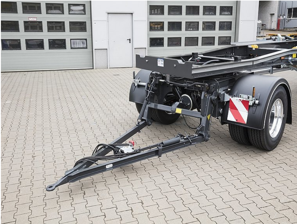
Opuszczony dyszel widłowy w przypadku załadunku przodem
