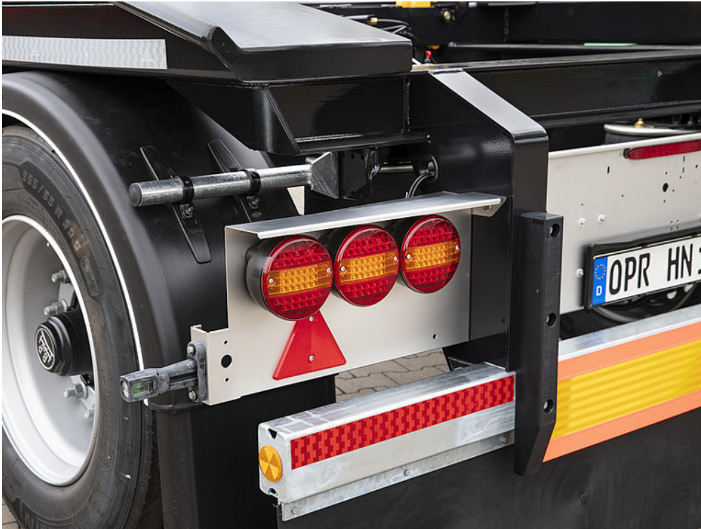
OPCJA WYPOSAŻENIA: 3 okrągłe światła tylne LED
