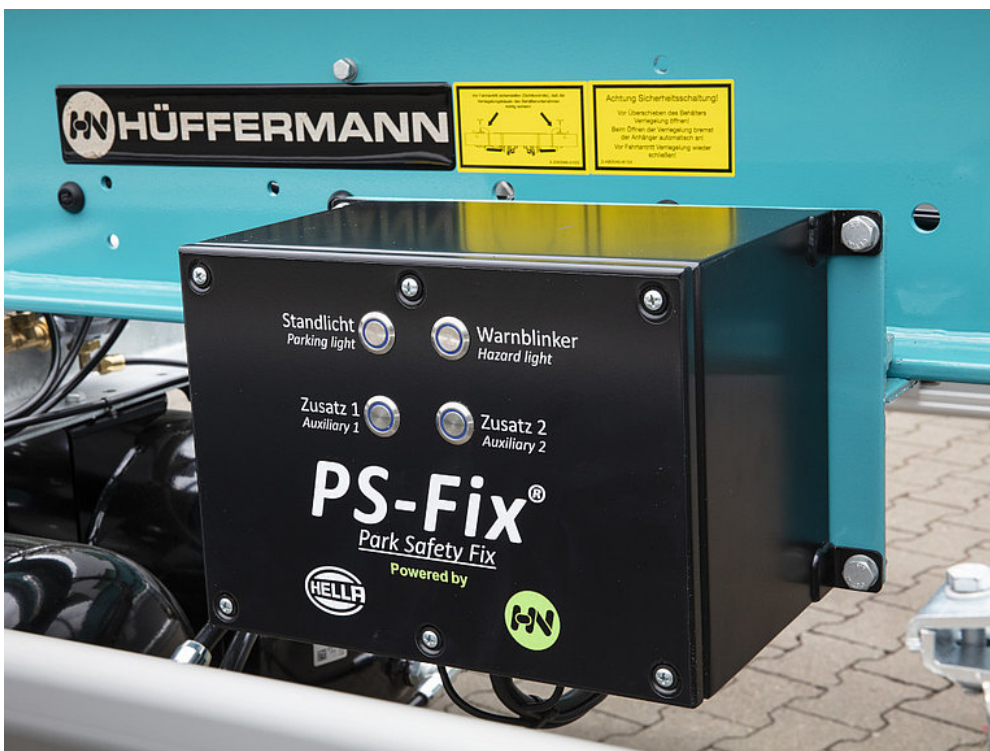
OPCJA WYPOSAŻENIA: System oświetlenia z własnym zasilaniem w celu zapewnienia większego bezpieczeństwa. PS-fix dysponuje czterema funkcjami: światło postojowe, funkcja migającego światła ostrzegawczego, oświetlenie dodatkowe i błyskowe.
