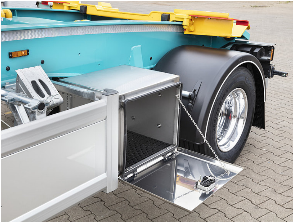
OPCJA WYPOSAŻENIA: Skrzynia ze stali nierdzewnej
