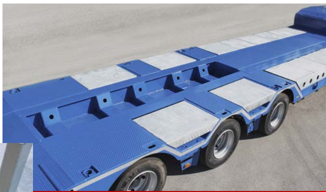
Wgłębienie na koparkę
