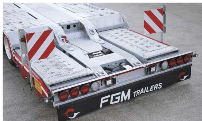
Duże panele do podłogi ładunkowej i światła
