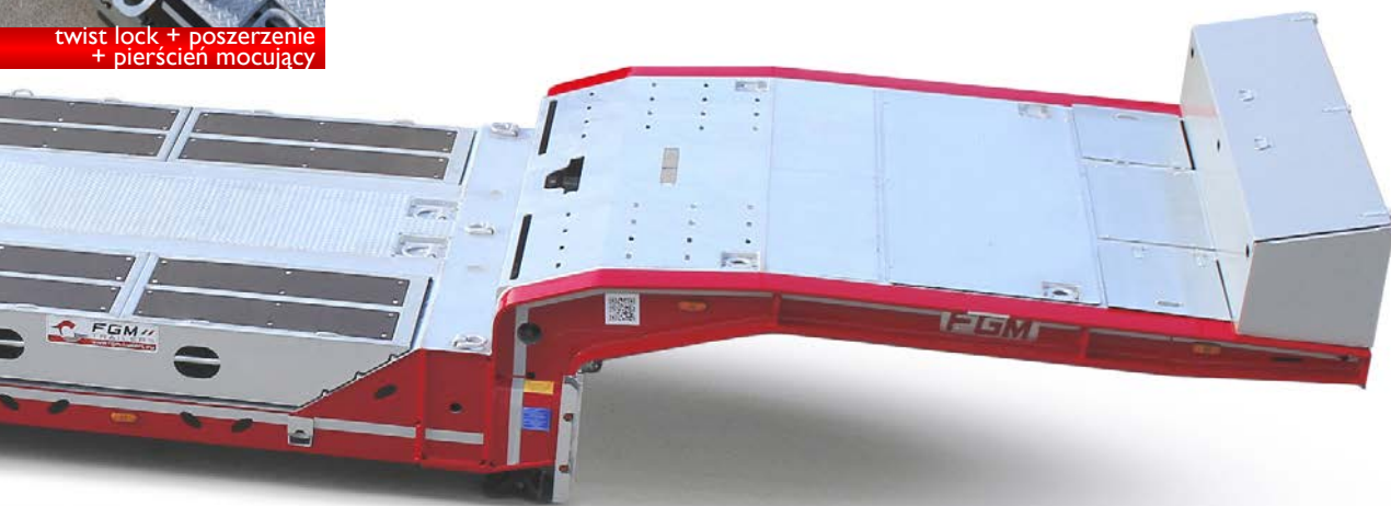
Podwozie teleskopowe + aluminiowe rampy
