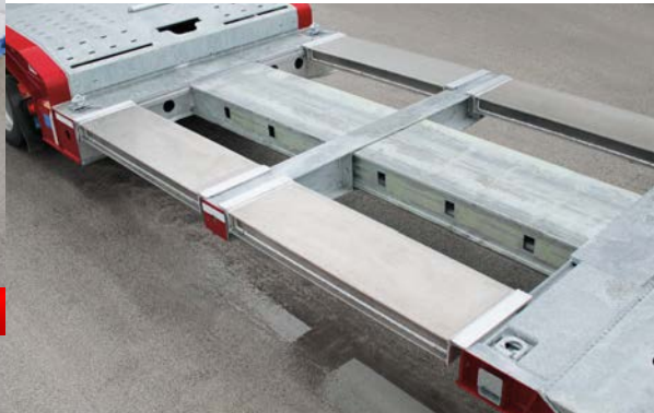
Podwozie teleskopowe + aluminiowe rampy
